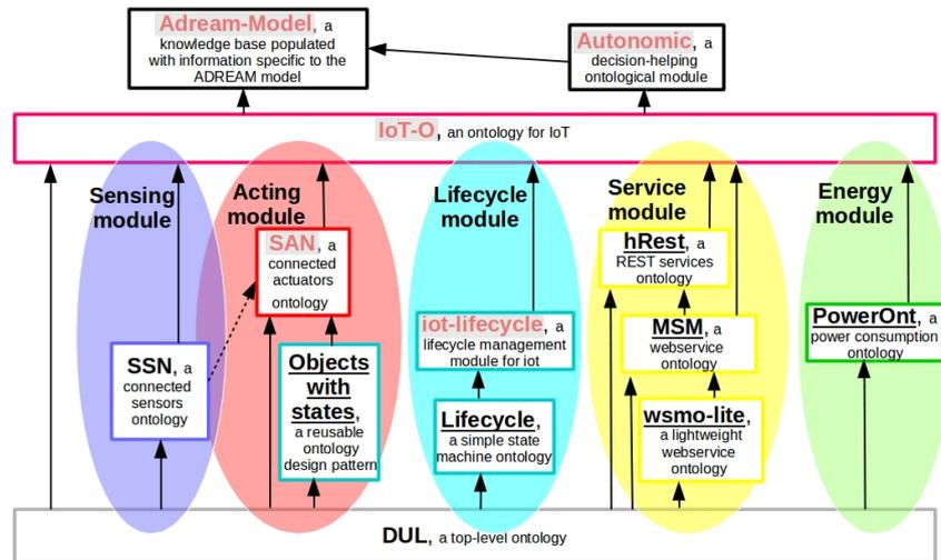
Figure 3: Architecture de haut niveau de IoT-O
