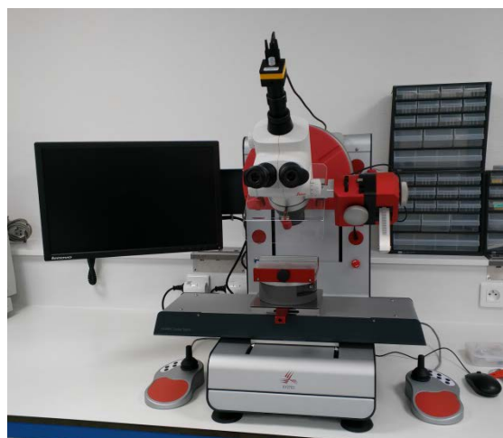
Equipement de traction/cisaillement Xyztec
