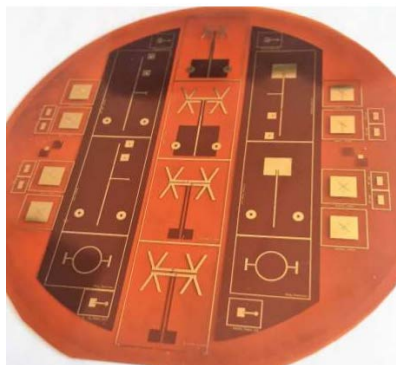
Antennes RF sur substrat souple avec plan de masse face arrière
