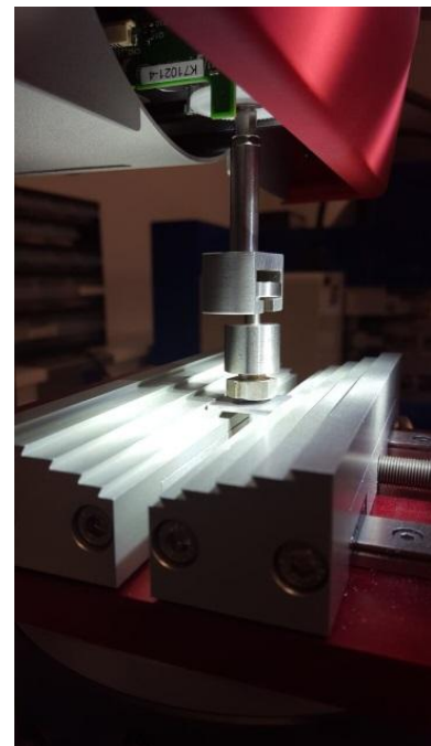
Figure 17 – banc de test pour la résistance mécanique des soudures (Arrachement)
