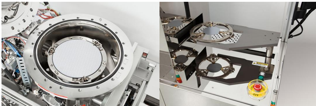
Figure 7 – Cuve de soudure avec chargement latéral du wafer
