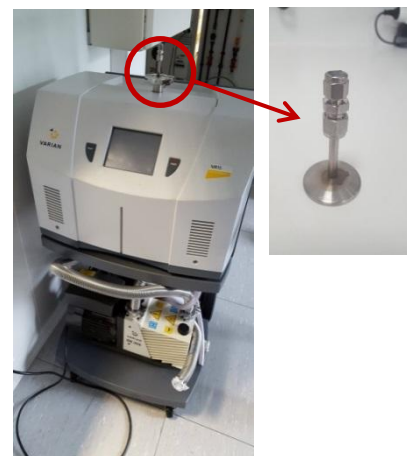
Figure 18 – Machine test d'herméticité et support de puces
