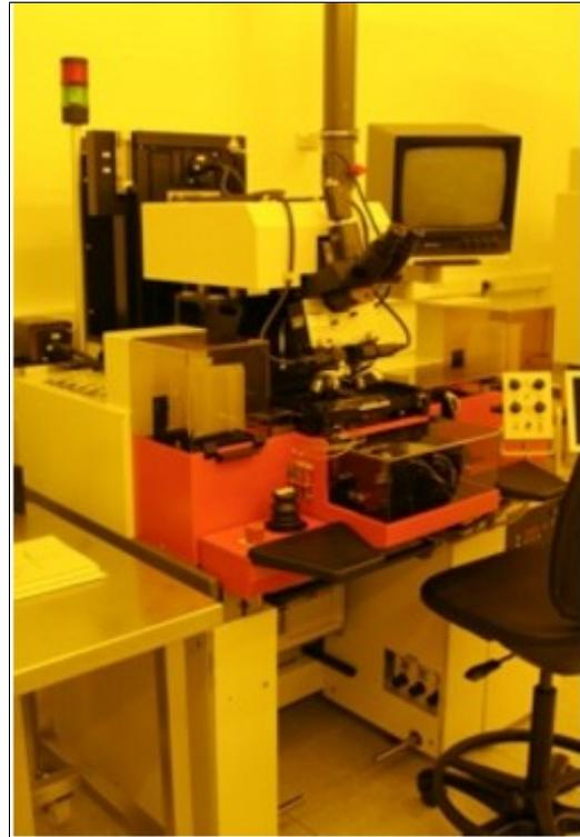
Figure 11 : Aligneur de masque MA150 du LAAS
