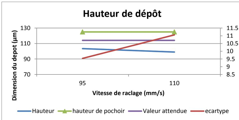
Figure 28 : Mesures hauteur de dépôt SQFP 112
