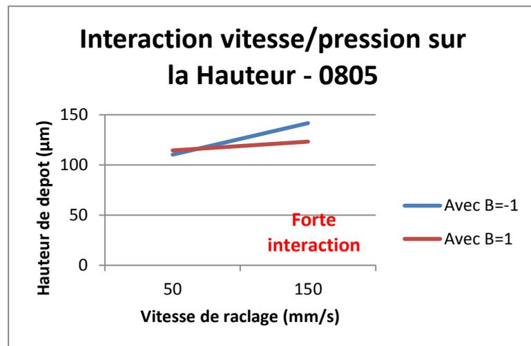
Figure 22 : Interaction vitesse/pression sur hauteur de dépôt Cap 0805
