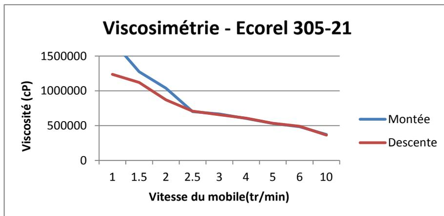
Figure 18 : Test de viscosimétrie Ecorel 305-21
