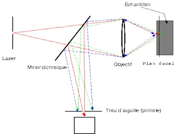
Figure 5 : Principe de fonctionnement du microscope confocal
