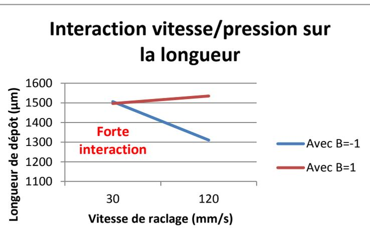
Figure 13 : Interaction vitesse/pression sur longueur dépôt Cap 0402
