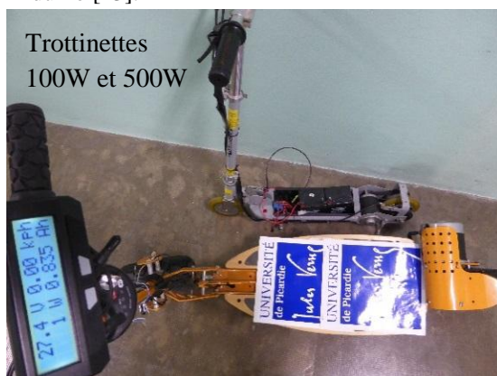
fig. 1 Modèle 100W pour moins de 60kg et modèle 500W pour 120kg avec son instrumentation.
