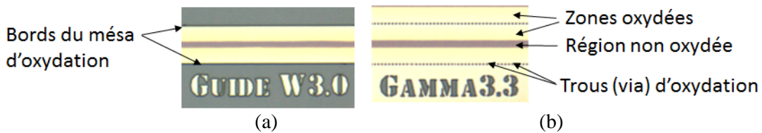
Fig. 2 : Images au microscope optique des guides fabriqués par (a) méthode conventionnelle et (b) planaire.
