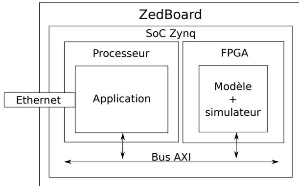
Figure 1 – Architecture de la plateforme matérielle.
