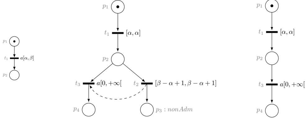
FIGURE 2 – Décomposition des contraintes temporelles  $[\alpha, \beta]$  associées à une transition étiquetée par un événement  $a$  : à gauche le réseau initial, au milieu la décomposition et à droite la décomposition dans le cas où  $\alpha > 0$  et  $\beta$  est infini.
