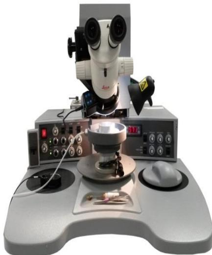
**Figure 10 : micro soudeuse semi-automatique K&S 4526**
