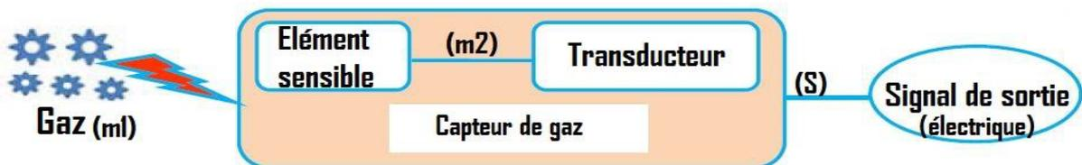
**Figure 1 : Principe de détection d'un capteur de gaz [8]**
