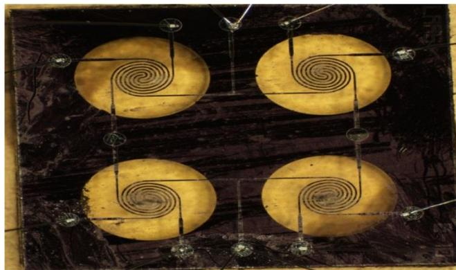
Figure 4 : puce qui contient quatre capteurs indépendants
