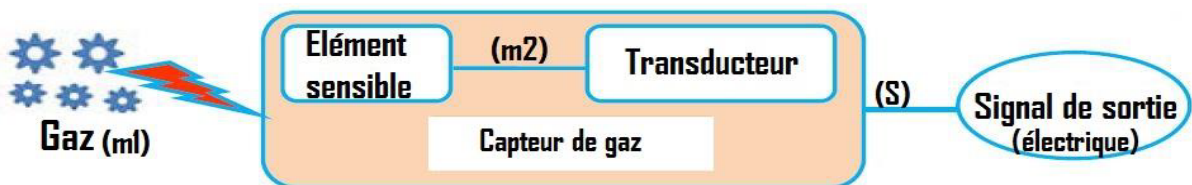
Figure 1 : Principe de détection d'un capteur de gaz [8]
