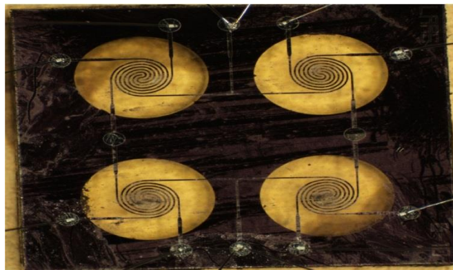
Figure 4 : puce qui contient quatre capteurs indépendants
