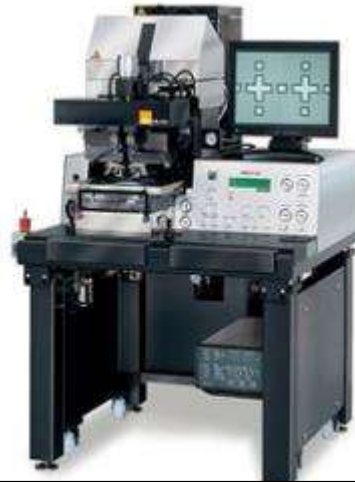
Machine d'alignement MA6, budget ≈300K€
