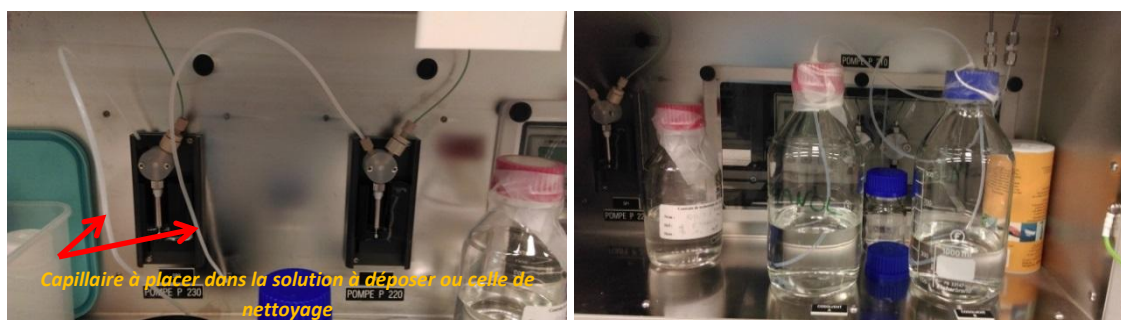
Figure 8 : installation des solutions de dépôt ou de nettoyage
