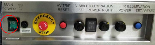
Fig.8 : mise en route machine
