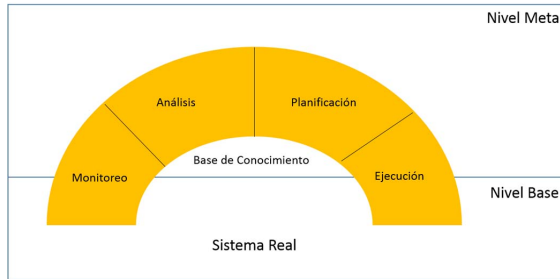
Figure 2. Arquitectura del Middleware basada en Computación Autónoma
