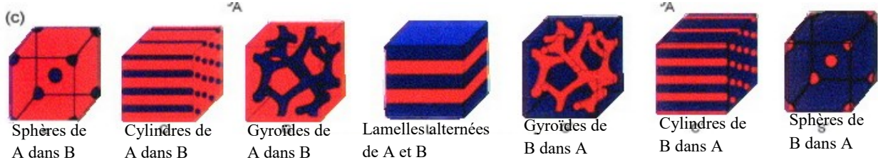
Figure 6 : auto-organisation des phases en fonction de la fraction volumique des constituants. [III]
