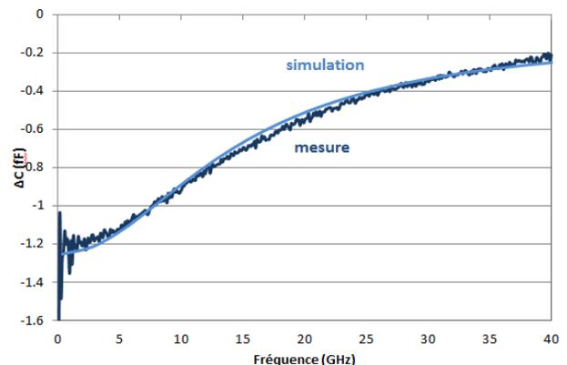
Figure 4. Comparaison simulation/mesure du contraste capacitif d'une bille de polystyrène de diamètre 10 $\mu\text{m}$  pour un biocapteur à coupure capacitive de 10 $\mu\text{m}$ .
