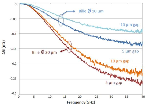
Figure 7. Contraste conductif des billes de polystyrène de diamètre de 10 $\mu\text{m}$  et 20 $\mu\text{m}$  pour des biocapteurs avec coupure capacitive de 5 $\mu\text{m}$  et 10 $\mu\text{m}$
