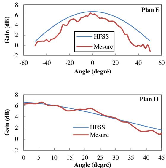
Figure 5. Diagramme de rayonnement de l'antenne patch
