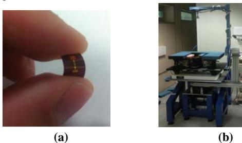
Figure 3. Antenne patch fabriqué (a) et banc de mesure pour le diagramme de rayonnement(b).
