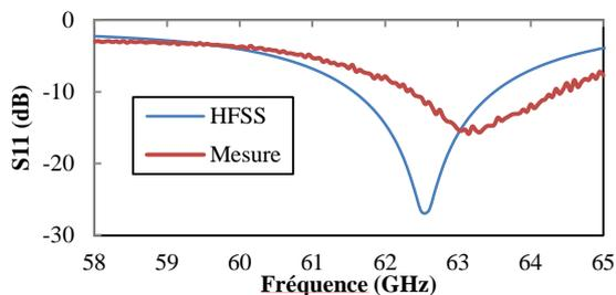
Figure 4. Coefficient de la réflexion de l'antenne patch
