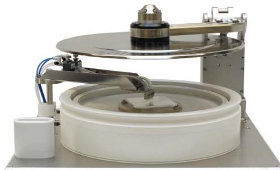
Depuis le 1<sup>er</sup> février 2018, la zone de lithographie optique de la Centrale de Technologie du LAAS accueille un nouvel équipement d'enduction de polymères en ambiance contrôlée par centrifugation, le Coater QSC200BM avec système rotatif RCCT de OBDUCAT.
