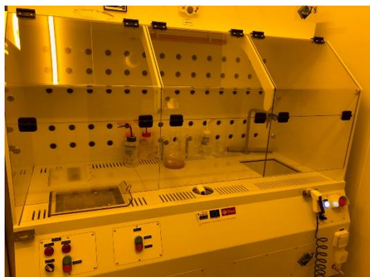
La modification de la hotte nettoyage masque s'est faite en octobre 2018 et porte sur l'intégration d'un bac Piranha et d'un bac de rinçage avec contrôle de la résistivité de l'eau. Ces modifications permettent une amélioration de la répétabilité des opérations et donc une meilleure qualité des nettoyages des masques.
