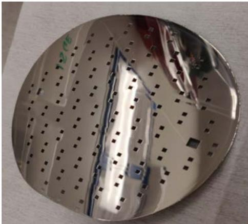
Shadow Masque en Nickel 150  $\mu\text{m}$
