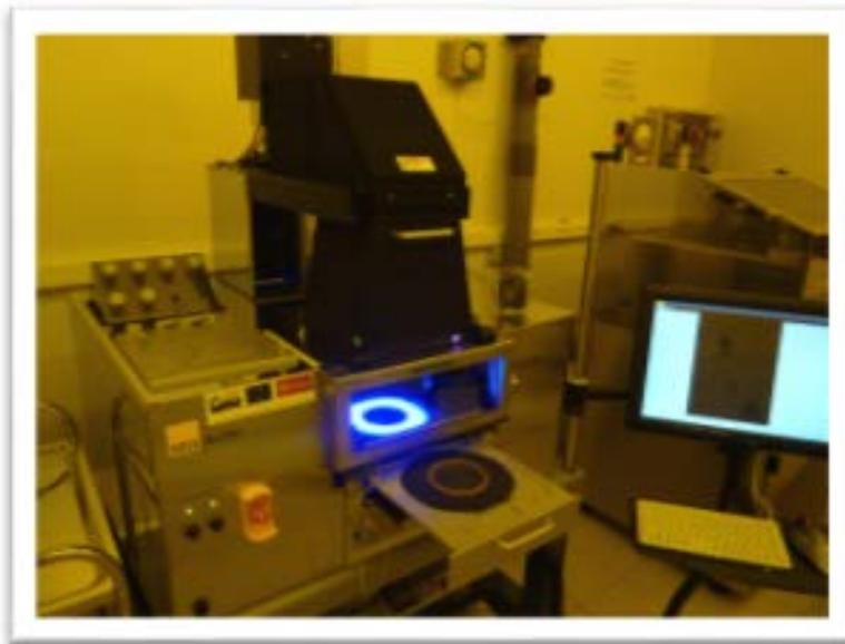
Installée le 9 Avril 2018, la nouvelle machine d'alignement de masque Suss Microtec MA6 Gen4 permet l'exposition UV de résines de photolithographie. Les membres de la zone photolithographie ont d'ailleurs été impliqués dans la conception de l'équipement chez le constructeur. Il s'agit du premier équipement avec un système d'exposition UV par LED installé par Suss Microtec en France. Ses caractéristiques sont :
