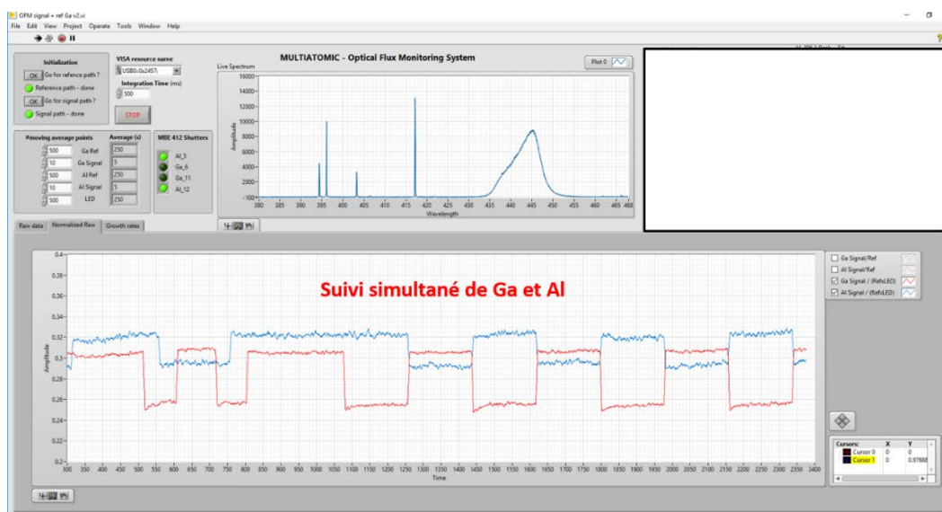
Capture d'écran de l'outil de mesure de flux par absorption atomique. Les changements de niveau correspondent aux ouvertures et fermeture des caches des cellules de Ga et d'Al.
