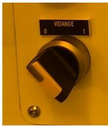
Figure 1 : commande vidange du bac chauffant
