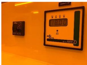
Figure 5 : mesure de la résistivité de l'eau de rinçage
