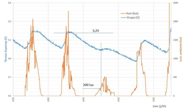
Figure 20. Evolution de la luminosité et de la tension des supercapacités sur trois jours.
