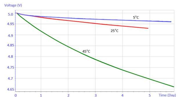
Figure 6. Influence de la température sur l'autodécharge.
