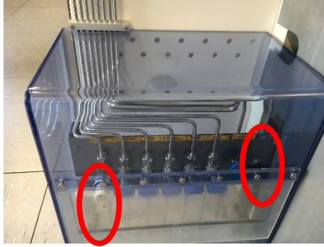
Figure 7 : vannes \text{SiH}_4 (à gauche) et AC (à droite).
