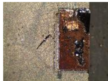
Cuivre oxydé lors de la thermocompression
