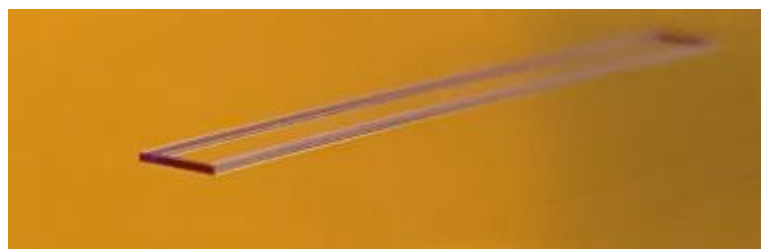
Figure 2 : WBR2100 pour la fabrication d'un shadow mask
