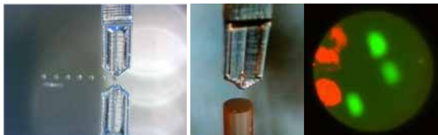
Figure 5: dépôt de solutions à l'aide d'un bioplume en polymère sur un substrat de silicium (à gauche) et sur une fibre optique (à droite)
