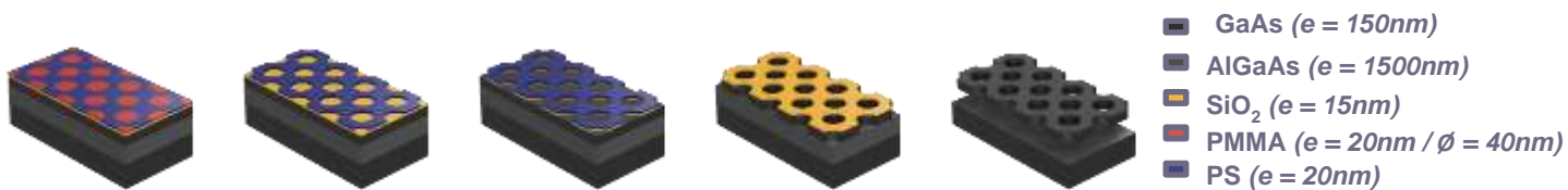
Procédé de nanostructuration de membranes photoniques en GaAs au moyen de Copolymères à Blocs de 80nm
