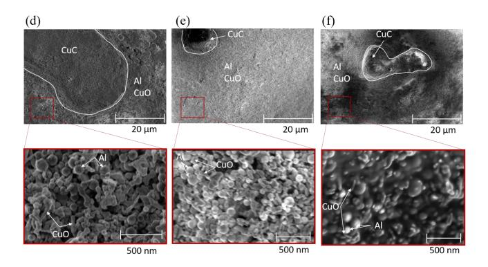
**Figure 3.** SEM images of Al/CuO\_ref (a + insert), TC\_ref (b + insert), TC\_3% (c + insert), TC\_5% (d + insert), TC\_10% (e + insert), TC\_25%(f + insert).
