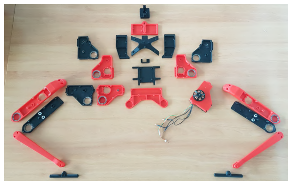
FIGURE 2.5 – Pièces issues de l'imprimante 3D, avec un moteur assemblé
