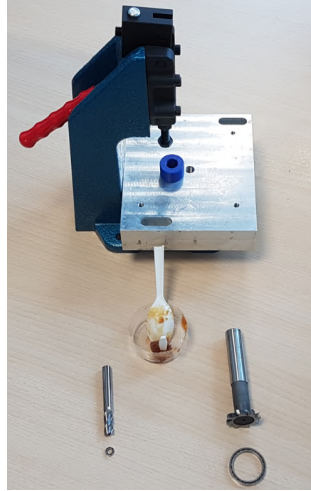
FIGURE 2.10 – Outils de pose des roulements. De haut en bas : presse manuelle, graisse, fraises et roulements
