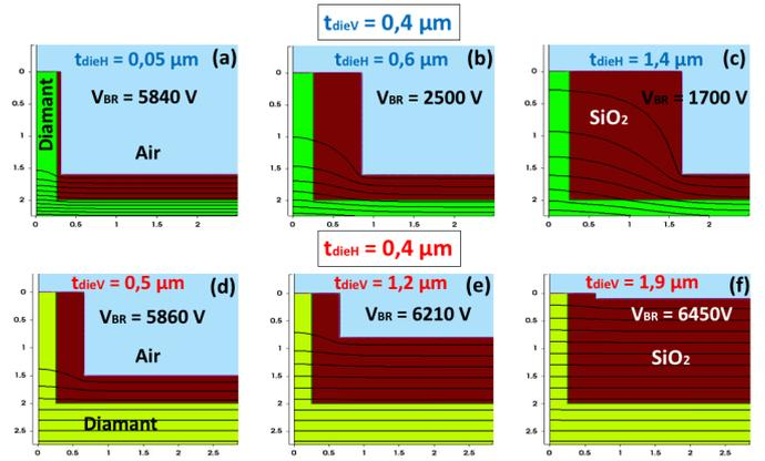
Fig. 6 : Représentation des lignes équipotentielles au moment du claquage en fonction de t<sub>dieH</sub> ou t<sub>dieV</sub> pour t<sub>dieV</sub> = 0,4 μm (Blue) et t<sub>dieH</sub> = 0,4 μm (Rouge) respectivement à 300 K
