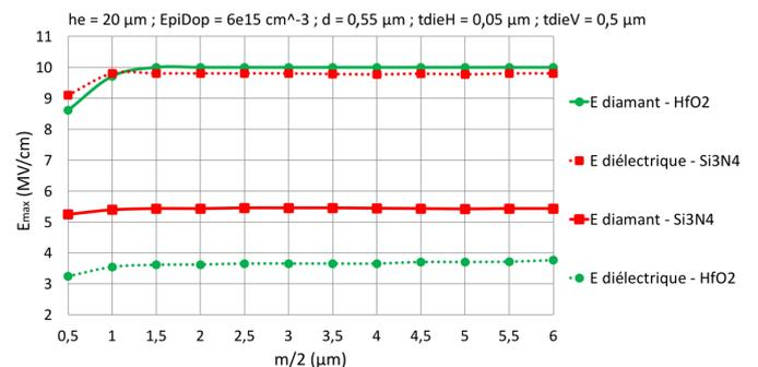
Fig. 8 : Variation du champ électrique maximal en fonction de m/2 dans le diamant et dans le diélectrique au moment du claquage à 300 K.
