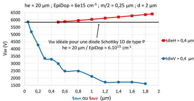
Fig. 5 : Variation de la tenue en tension en fonction de t<sub>dieH</sub> ou t<sub>dieV</sub> pour t<sub>dieV</sub> = 0,4 μm (courbe en Blue) et t<sub>dieH</sub> = 0,4 μm (courbe en Rouge) respectivement à 300 K.
