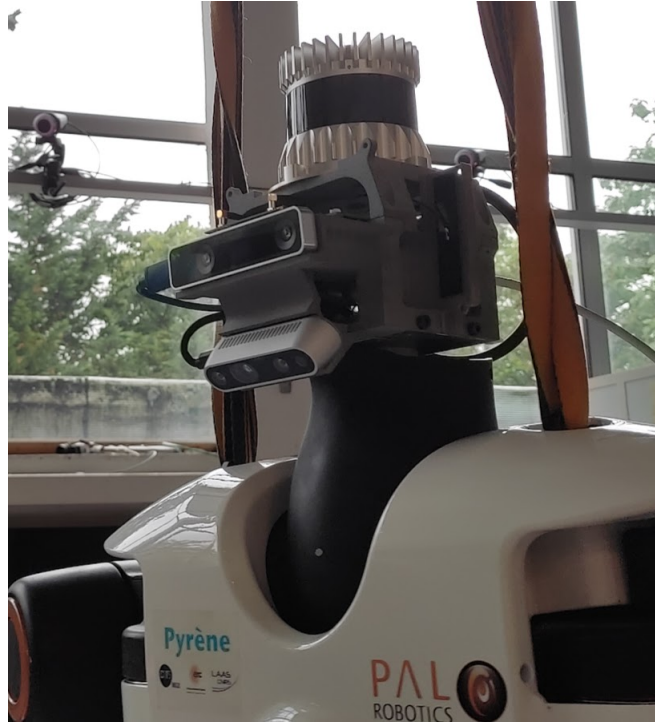
FIGURE 1.4 – Tête de Pyrène (on y voit le LiDAR, la caméra stéréovision et la caméra de profondeur - respectivement de haut en bas.)
