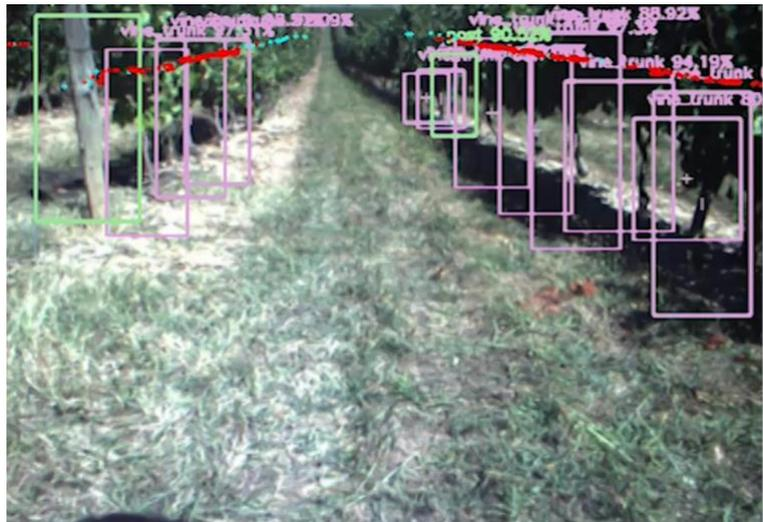
Figure 2 : Vue de la rangée par la caméra du robot, avec les différents pieds de vigne détectés (© LAAS/CNRS)
