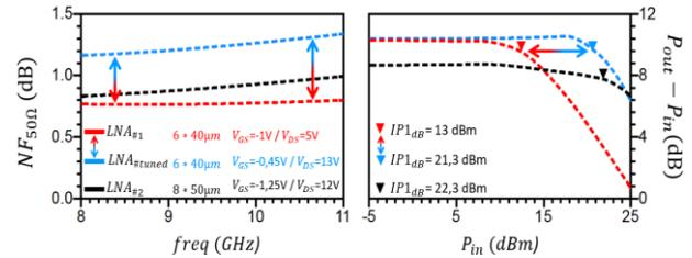
Figure 1 : Facteur de bruit sur la bande 8-11 GHz (Gauche) et le gain en fonction de la puissance en entrée (Droite) pour les 3 stratégies : LNA<sub>#1</sub> et sa polarisation robuste LNA<sub>#tuned</sub> ainsi que LNA<sub>#2</sub>.
