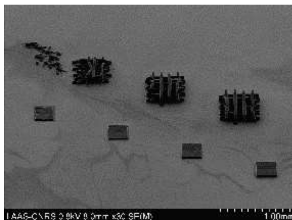
Figure 6: Structure 3D en résine IP-PDMS.
