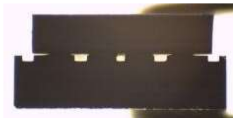
Report flip chip de puces millimétriques par frittage de pâte à fritter
