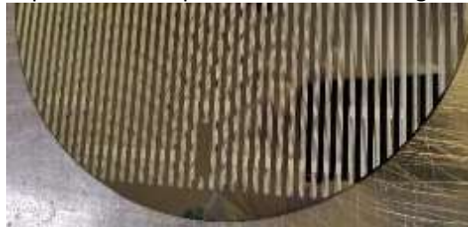
Sérigraphie de pâte à braser sur wafer silicium 8 pouces
