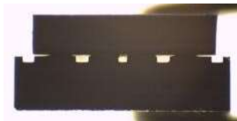
Report flip chip de puces millimétrique par frittage de pâte à fritter
