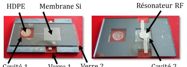
Figure 1. Présentation du capteur – vue de dessus (gauche) et de dessous (droite)
