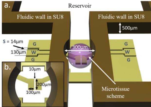
**Figure 2. Schéma détaillé du dispositif RF avec le schéma d'un sphéroïde en son centre. a) Vision globale ; W = Signal ; S = fente ; G = Masse. b) Zoom sur la partie centrale du capteur avec les dimensions des électrodes et de la coupure capacitive.**
