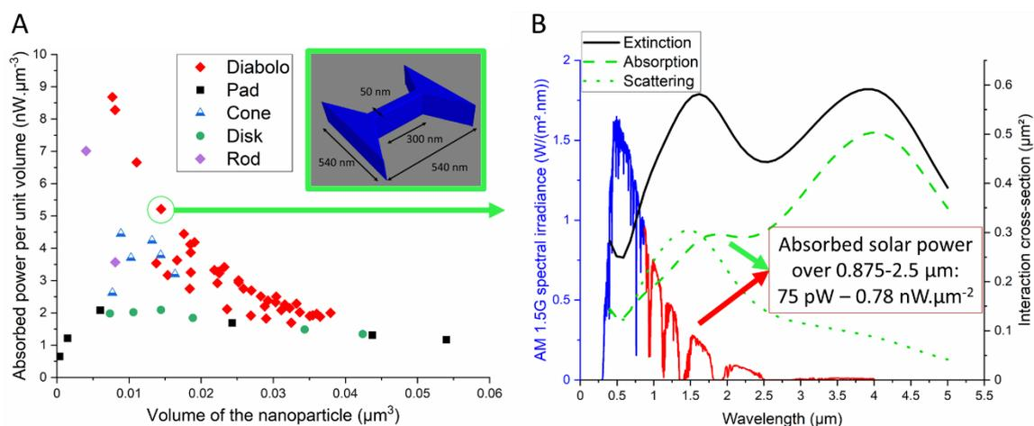
Figure 1 : (A) Absorption solaire calculée sur la gamme 0,875-2,5 μm pour des nano-antennes en nickel de différentes formes. La structure encadrée représente le diabolo correspondant au point entouré. (B) Sections efficaces d'interaction calculées pour le diabolo encadré et spectre solaire AM 1.5G au-dessus (bleu) et en-dessous (rouge) de l'énergie de la bande interdite d'une cellule GaAs.
