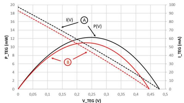
Figure 11. Relevés de  $I(V)$  et  $P(V)$  avec  $\Delta T$  constant, ( $T_{HOT} = 70 \text{ } ^\circ\text{C}$ ,  $T_{AMB} = 23 \text{ } ^\circ\text{C}$ ) mais deux points de fonctionnement initiaux différents.
