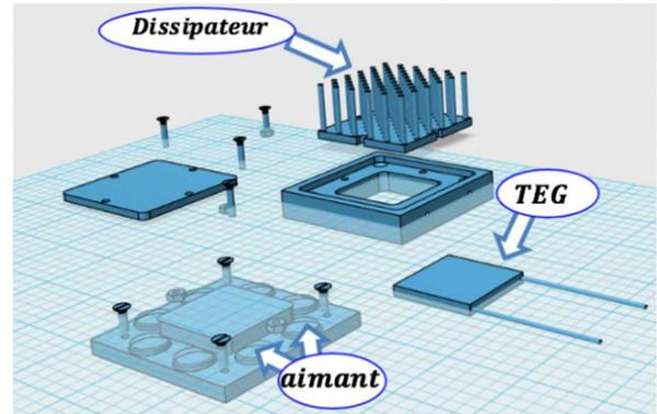
Figure 7. Vue éclatée du dispositif.
