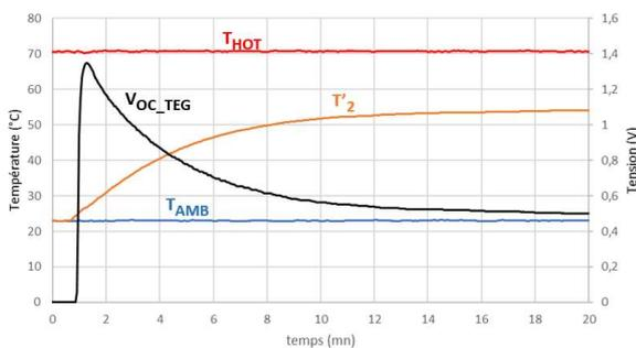
Figure 10. Evolution de  $V_{oc}$  et de  $T'_2$ .
