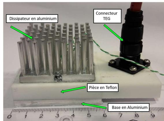
Figure 8. Récupérateur d'énergie assemblé.
