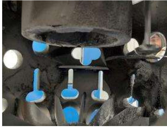
Vue à l'intérieur de l'ancien panneau cryogénique du MBE412
