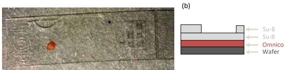
Figure 1: (a) Substrat d'impression 3D en SU-8 ; (b) Schéma de fabrication par photolithographie (Bastien Venzac et Janis Drobecq)
