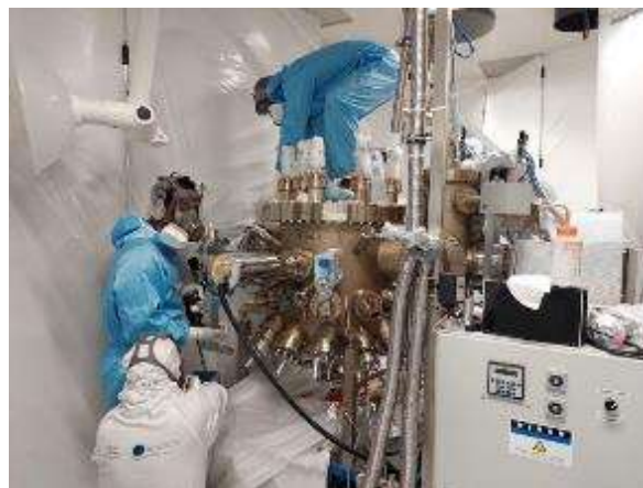
Mise en place du nouveau panneau cryogénique du MBE412
