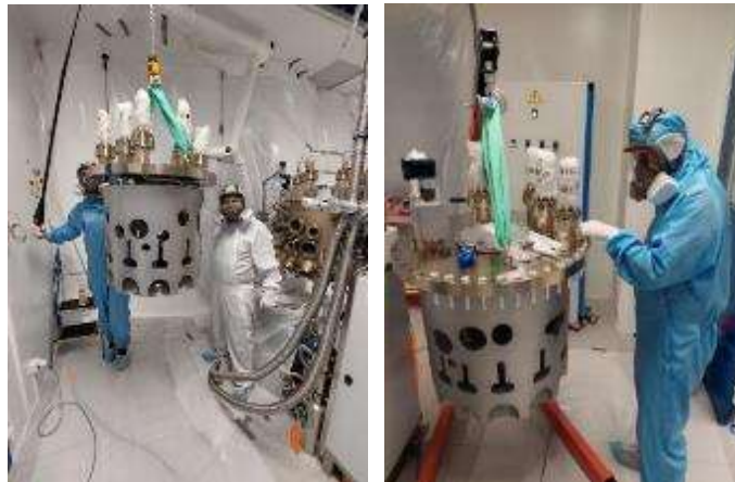
Mise en place du nouveau panneau cryogénique du MBE412
