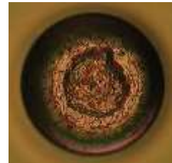
Bumps après test de cisaillement
