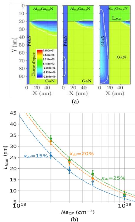
Fig. 5. Variations de  $L_{ZCE}$  pour différentes largeurs des puits P-GaN, 2.5 nm, 7 nm et 18 nm (a) ; évolution de  $L_{Tmin}$  en fonction de  $N_{aCP}$  pour différents taux d'aluminium  $x_{Al}$  dans l'AlGaIn de 15%, 20% et 25% (b).
