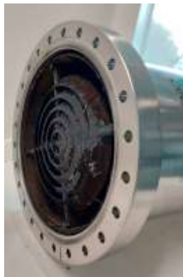
Pompe cryogénique du MBE412 saturée
