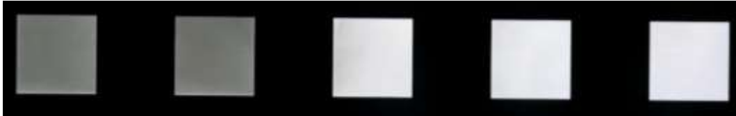
Ablation couche métallique sur verre avec l'équipement FEMTIKA
