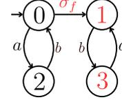
Figura 10. Autômato  $G$  com o comportamento pós-falha.
