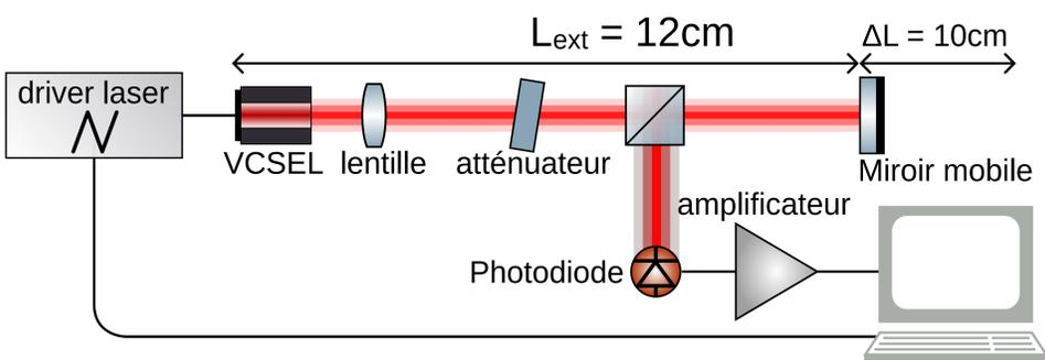
Description schématique du banc de mesure
