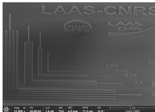
Fig Image SEM sur la résine HSQ Médusa 84SiH épaisseur 200nm, résolution \approx 50nm
