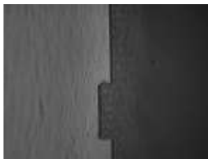
Figure 1 : Gravure d'un feuillet Kapton sans ébavures sur les bords
