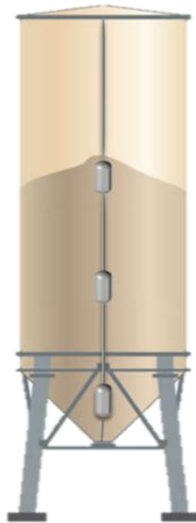
Figure 43 : Sonde SILOTEST 3 implémentée dans un silo
