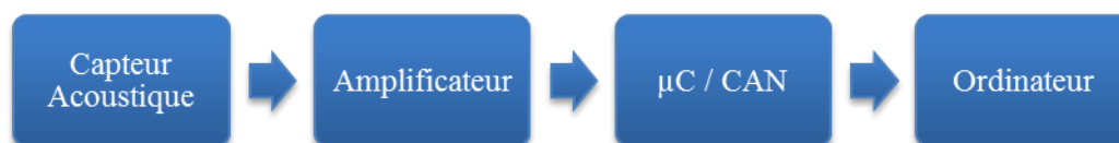
Figure 60 : Chaîne d'acquisition des signaux acoustiques
