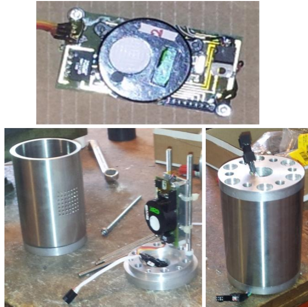
Figure 46 : Montage du module multi capteurs SILOTEST 3
