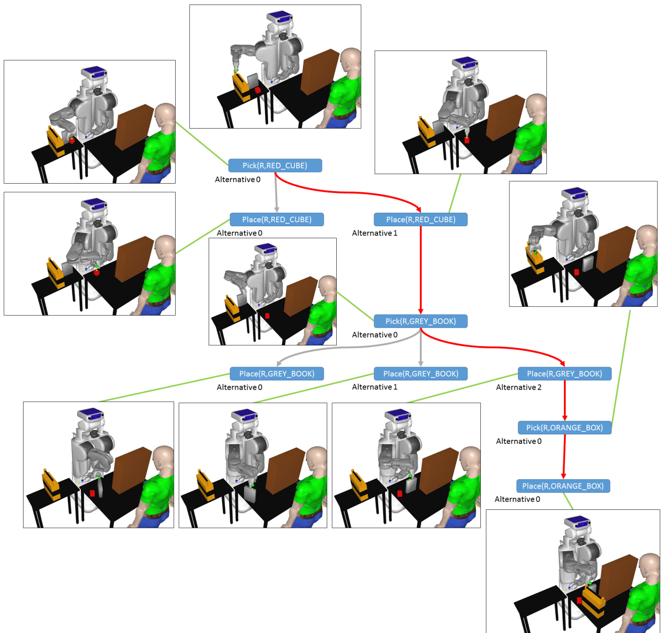
FIGURE A.15: Les différentes étapes d'un plan géométrique incluant les alternatives non utilisées. Dans ce plan, le robot réussit à planifier trois Pick puis Place successifs de trois différents objets.
